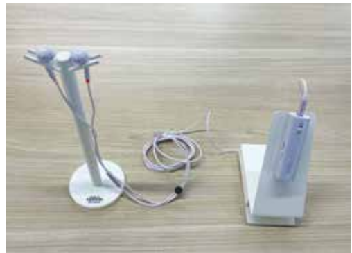
※軟骨伝導イヤホン 耳周辺の軟骨の振動を通じて音が聞こえる軟骨伝導を応用したもので、イヤホンを入らなくても明瞭に音が聞こえ、音漏れが少ない。
